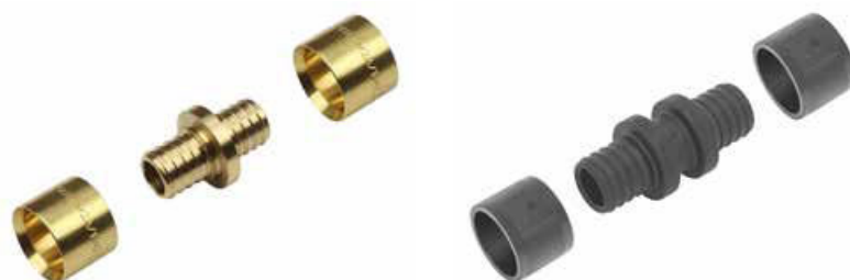
Рис. 48. Двосторонній з'єднувач KAN-therm Push для труб PEXC, PERT і blueFLOOR PERT діаметрами 12×2; 14×2; 18×2; 18×2,5; 25×3,5
